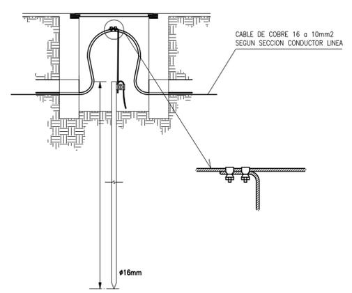
DETALLE CONEXIONADO PIQUETA A CONDUCTOR DE TIERRA
